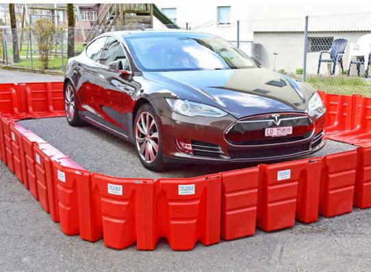
des Fahrzeugs bis auf eine mögliche Höhe von 50 cm zu fluten. Der Vorteil dabei ist, dass eine maximale Kühlung erreicht werden kann und das Wasser in Bereiche vordringt, wo das Löschwasser aus Strahlrohren nicht ausreichend ist. In kürzester Zeit kann so die Kühlung der schadhafte Akkus im Unterboden gewährleistet werden.»
